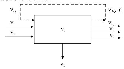
图2 电镀铜生产线用水单元水平衡示意图
